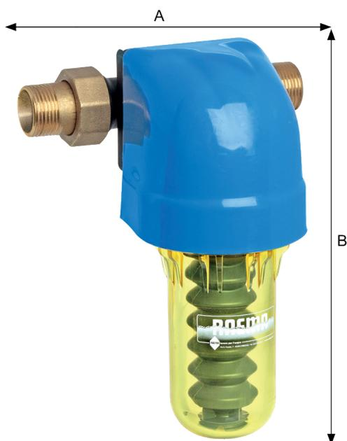
Il DOSAPOL P-AR è una apparecchiatura studiata per il dosaggio in acque potabili o tecniche di polifosfati per uso alimentare al fine di proteggere gli impianti da calcare e corrosione. È in plastica rinforzata con fibra di vetro e attacchi ruotabili a 360° con bocchettoni in ottone e ha una cover in testa di protezione per evitare manomissioni al datario e al sfiato in ottone.
